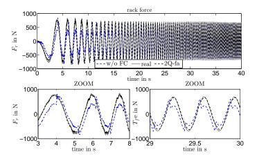
**FIGURE 10**. SIMULATION RESULTS FOR RACK FORCE ESTI-MATION
