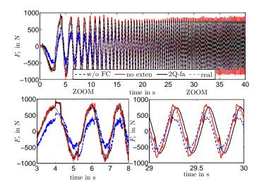
**FIGURE 11**. TEST RESULT FOR RACK FORCE ESTIMATION USING THE TEST-RIG WITH RACK FORCE SWEEP EXCITATION
