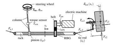
FIGURE 1. RACK-TYPE EPS LAYOUT
